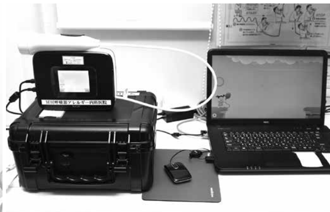
好酸球性炎症の数値を評価するNO（一酸化窒素）測定器
